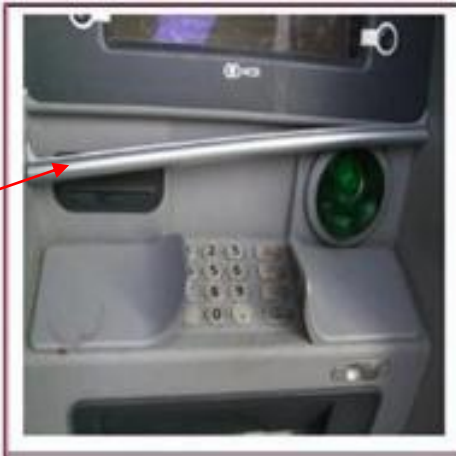
ВИДЕОКАМЕРА ДЛЯ ЧТЕНИЯ ПИН-КОДА
