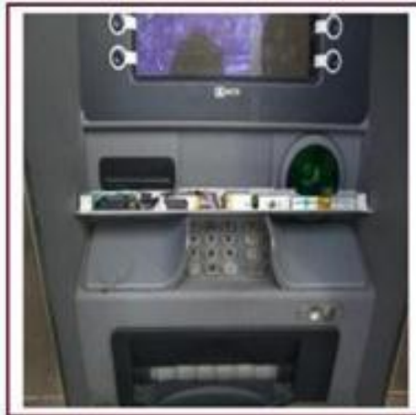
ВИДЕОКАМЕРА ДЛЯ ЧТЕНИЯ ПИН-КОДА
